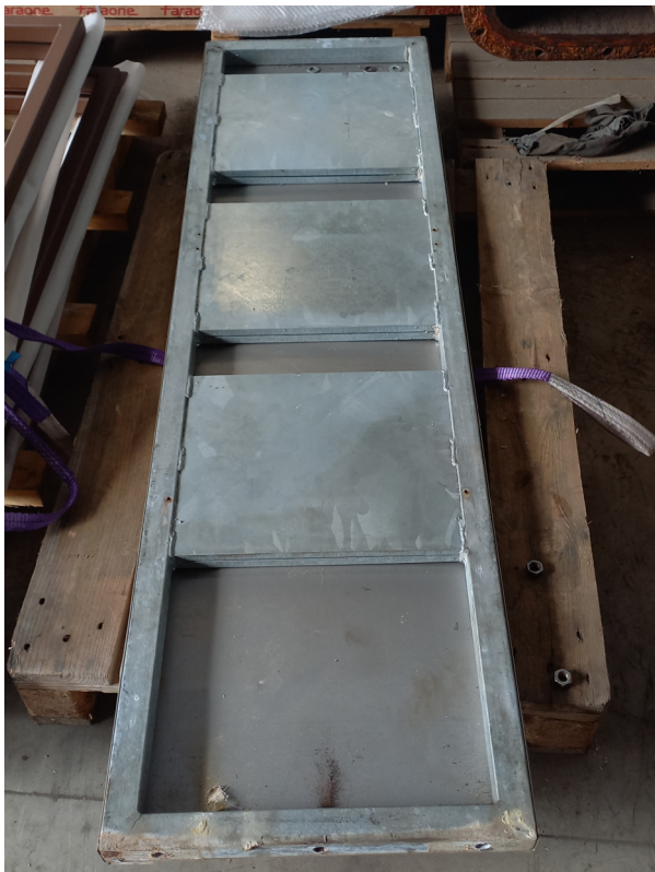
fig. 08 – Telaio e tre copie di lastre all'interno del pannello
