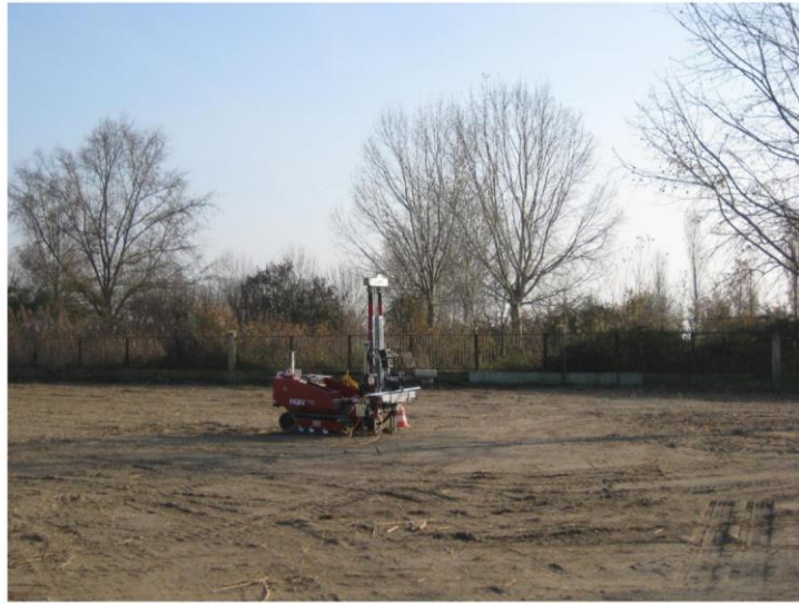
Foto 3: Esecuzione della prova CPTU3
