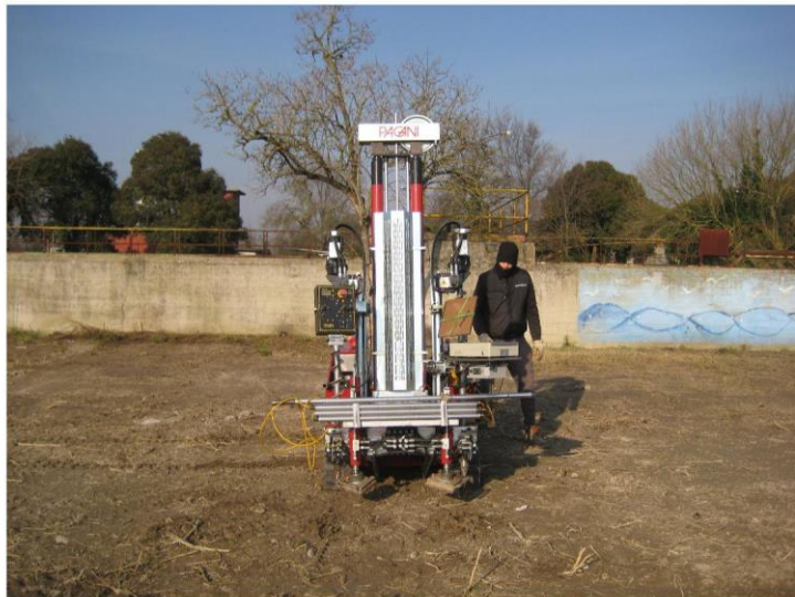
Foto 2: Esecuzione della prova CPTU2
