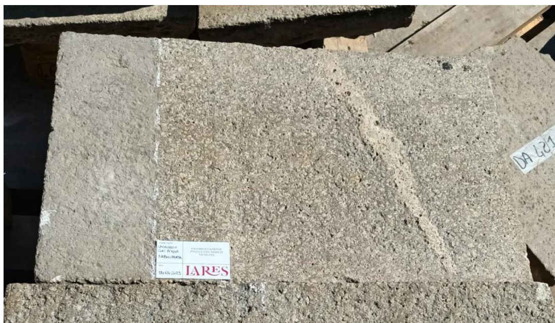
Figura 4–1 Dettaglio della campionatura del lavaggio con acqua atomizzata sulla porzione destra del masegno, sulla porzione sinistra è stata eseguita la sola pulizia meccanica.
