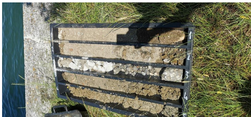
Figura 2.4: Carate estratte con residui della soletta in conglomerato cementizio
