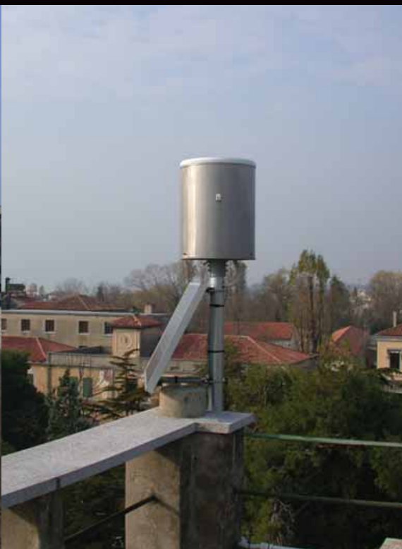
▼ Il raccogliitore pluviometrico sul terrazzo
