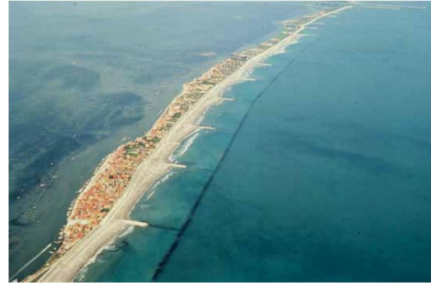
In alto, vista aerea complessiva del sistema delle difese a mare del litorale tra le bocche di Malamocco (sullo sfondo in alto) e Chioggia. Si nota la barriera soffolta sub-parallela alla linea di riva realizzata a protezione delle difese.
