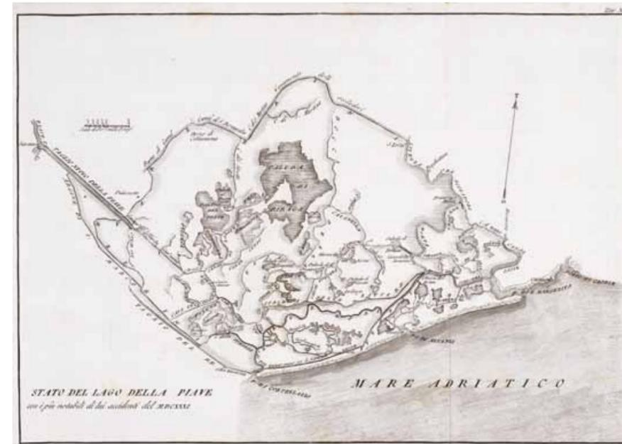
Il Lago della Piave, grande palude costiera nella quale fu inizialmente deviato il fiume mediante la realizzazione di un taglio diritto fra S. Donà e località Palazzetto nel tentativo, fallito, di spostarne lo sbocco al mare a Porto S. Margherita. Qui era stabilita la foce del Livenza, a sua volta spostato più a nord nella laguna di Caorle. (Bernardino Zandrini, 1811 Biblioteca Centrale della Facoltà di Ingegneria dell'Università di Padova)
