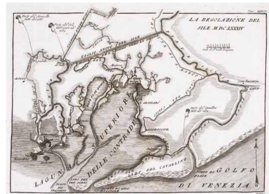
Il progetto del Taglio del Sile concepito per distogliere il fiume dal suo sbocco in laguna. L'intervento, realizzato a difesa dall'impaludamento della laguna superiore e in particolare dei centri di Torcello e Mazzorbo si completava con il collegamento del Taglio all'alveo abbandonato del Piave a Caposile. (Bernardino Zandrini, 1811 Biblioteca Centrale della Facoltà di Ingegneria dell'Università di Padova)
