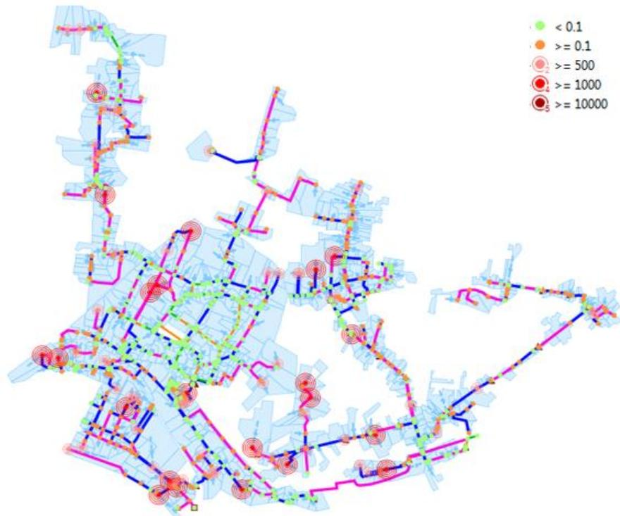
Figura 29. Schema della rete modellata con indicate le entità dei volumi esondati ai nodi per una evento con TR 20 anni e durata precipitazione pari a 30 minuti.
