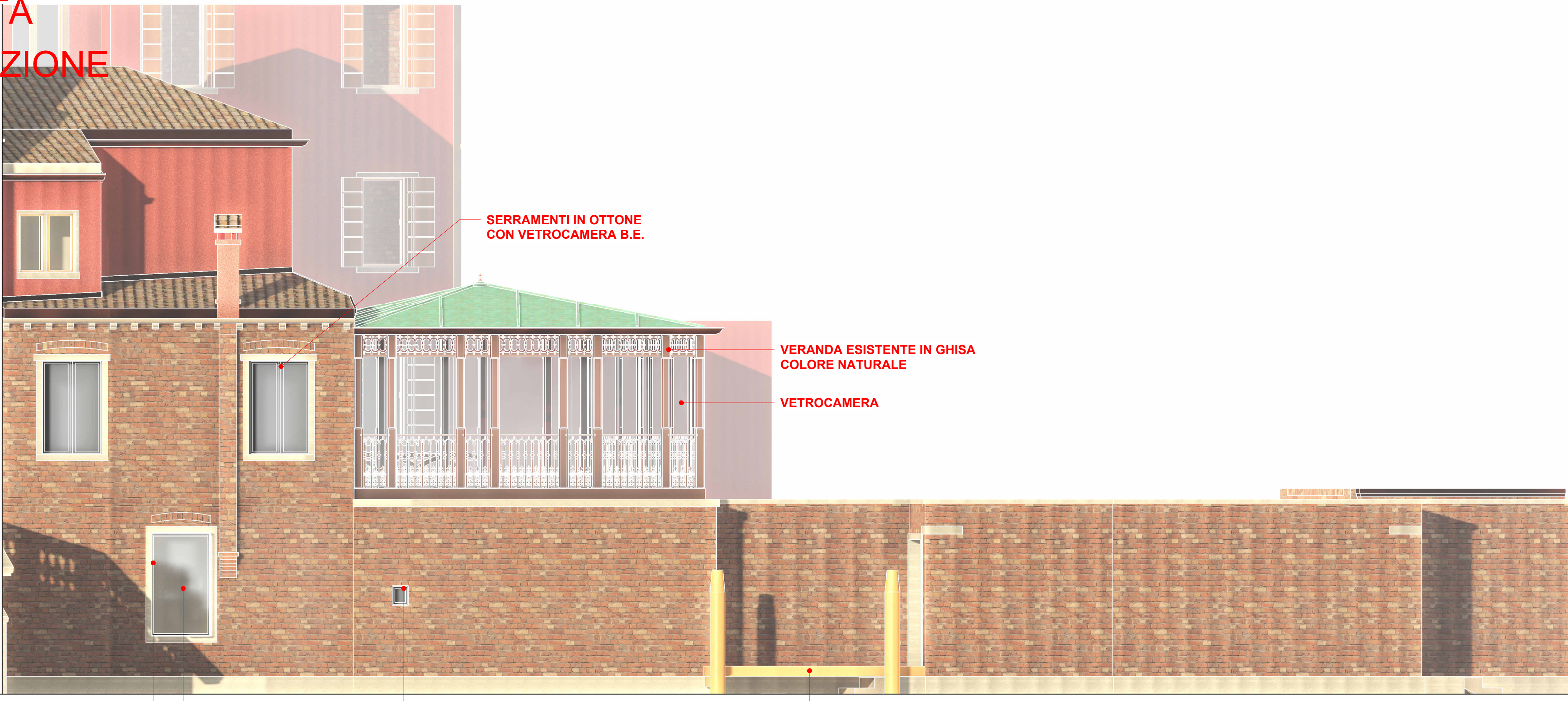
PARTICOLARE PROSPETTICO OVEST Scala: 1:50 | STATO DI PROGETTO
