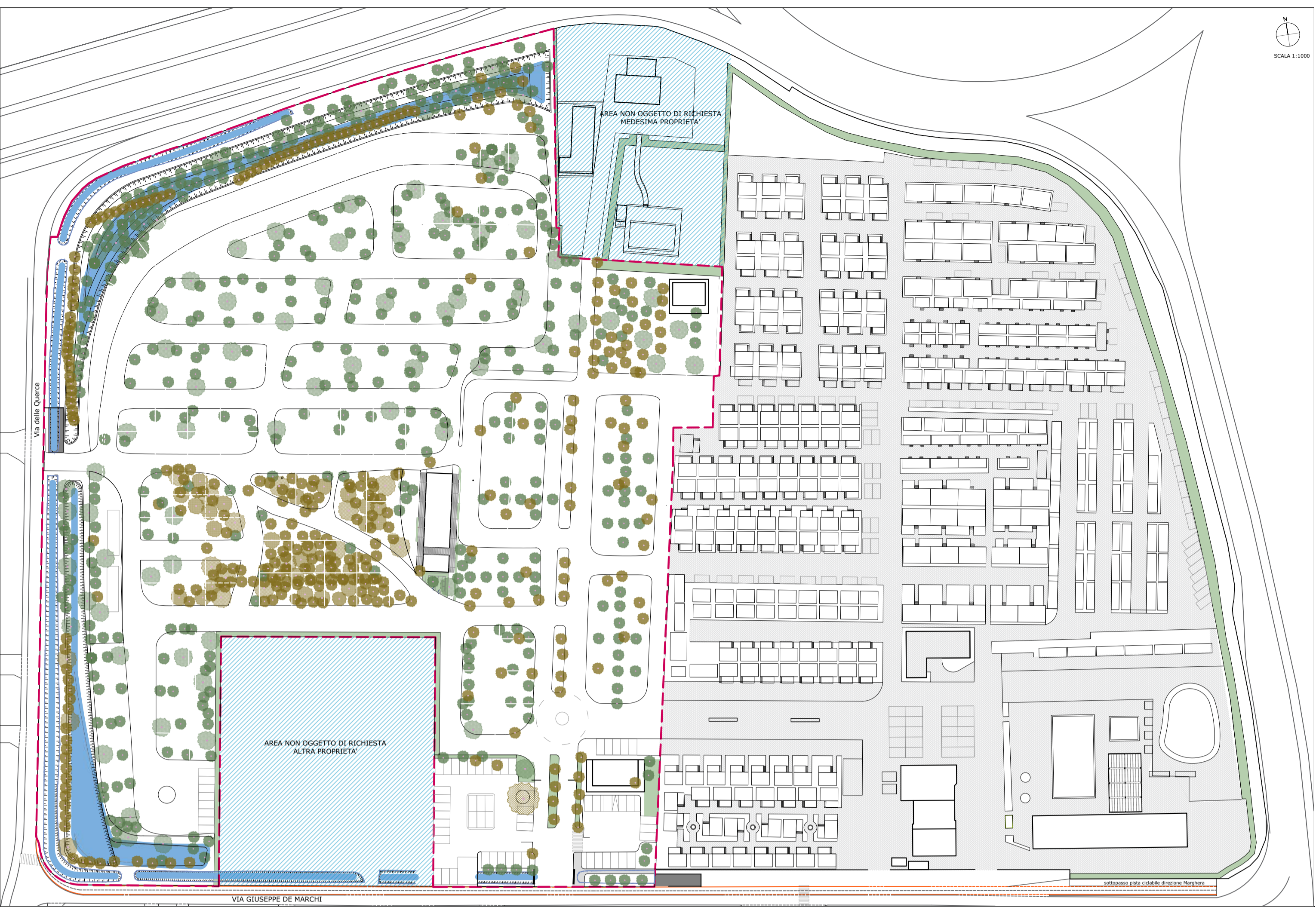
Planimetria aree verdi e predisposizione bacini di laminazione
