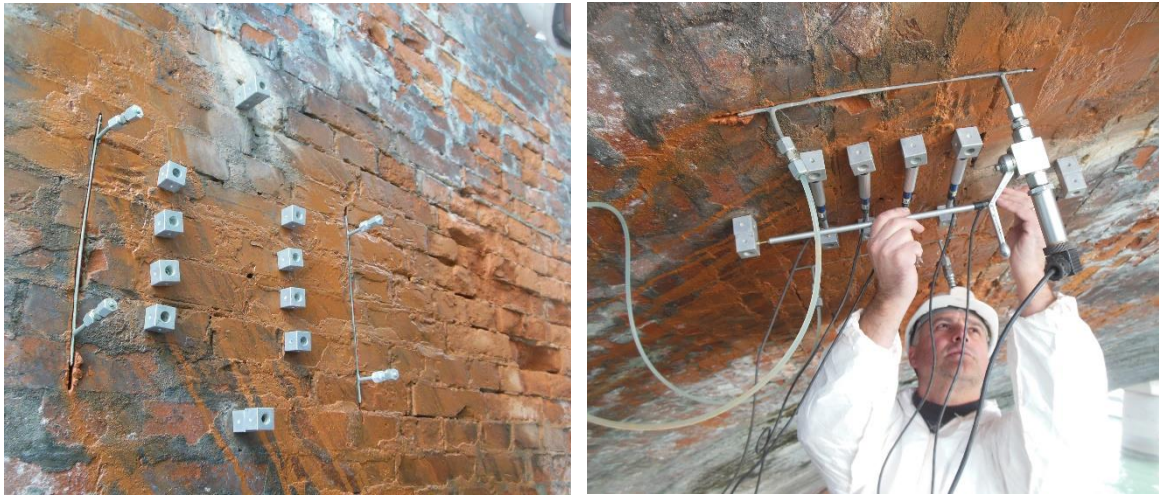
Figura 3-32: prova con martinetto piatto doppio MPD 3 – Disposizione dei sensori
