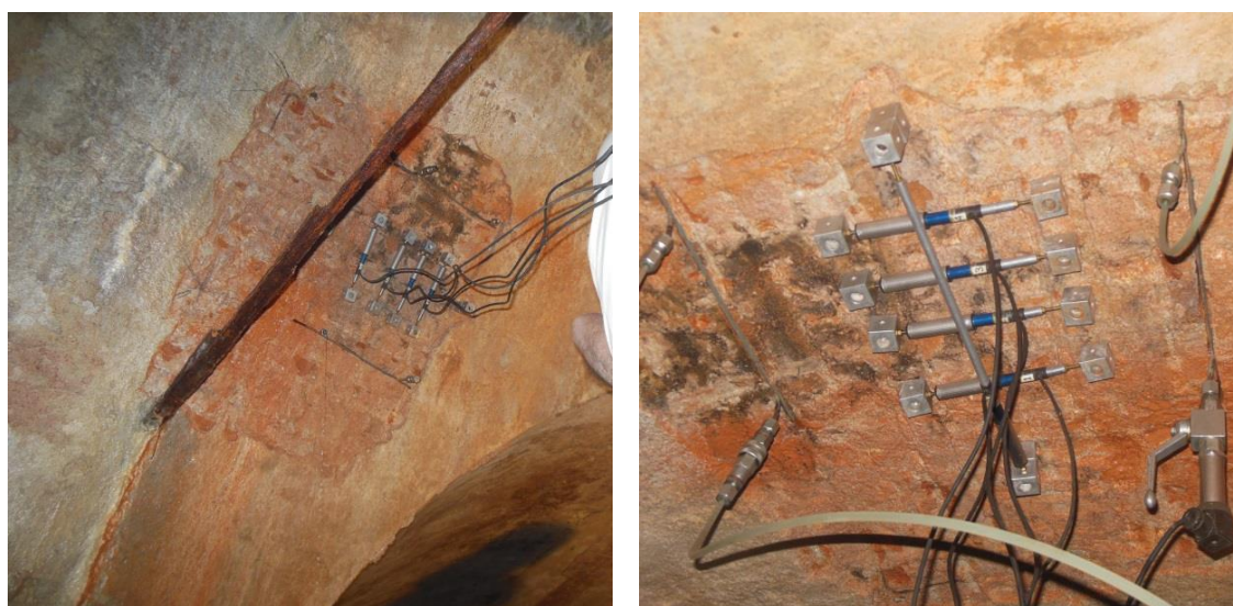
Figura 3-14: prova di martinetto piatto doppio: disposizione delle basi di misura e dei sensori
