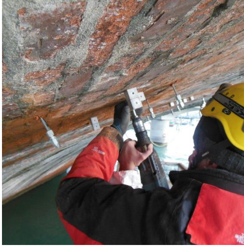
Figura 3-37: prova con martinetto piatto doppio MPD 4 – Disposizione dei sensori
