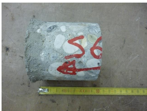
Figura 5-5: provini prima della rettifica
