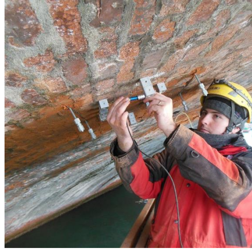
Figura 3-37: prova con martinetto piatto doppio MPD 4 – Disposizione dei sensori
