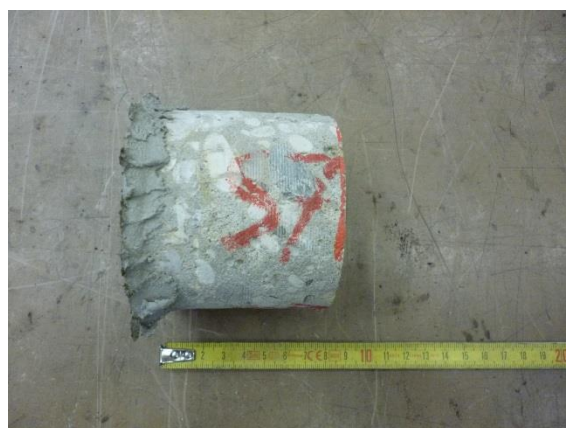
Figura 5-5: provini prima della rettifica
