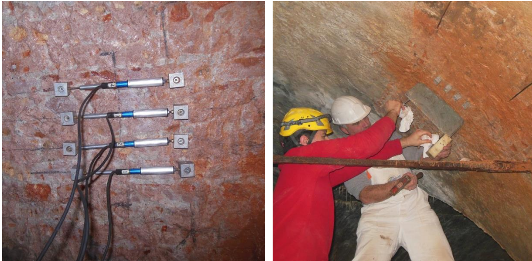
Figura 3-25: prova di martinetto piatto singolo MPS 2; individuazione prova; misura delle distanze iniziali; inserimento del martinetto
