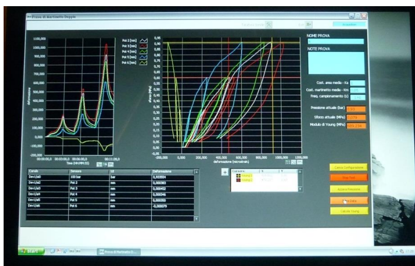
Figura 3-15: prova di martinetto piatto doppio, schermata del software di acquisizione durante l'esecuzione della prova
