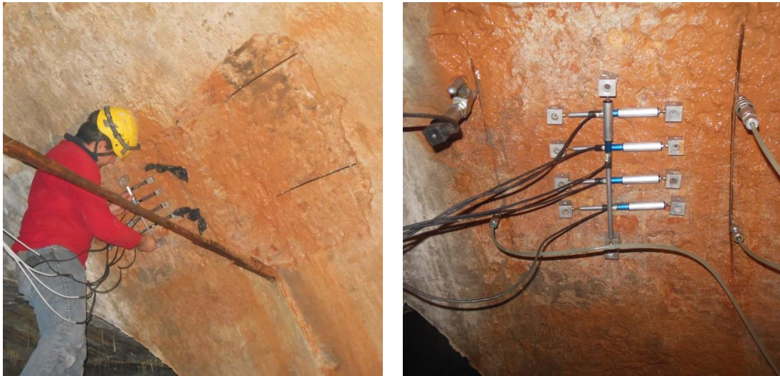
Figura 3-27: prova con martinetto piatto doppio MPD 2 – Disposizione dei sensori
