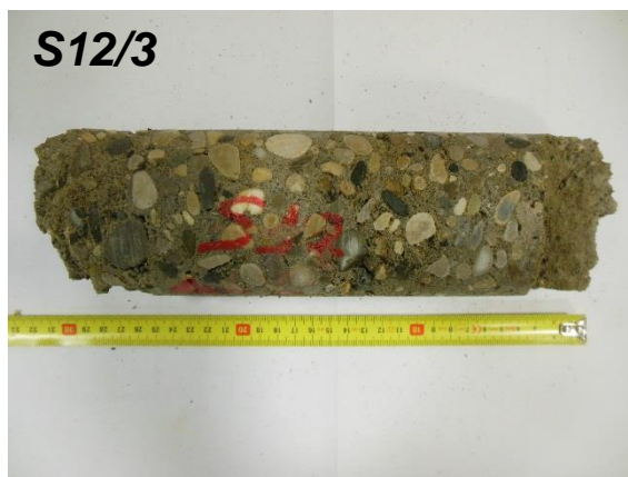
Figura 5-5: provini prima della rettifica
