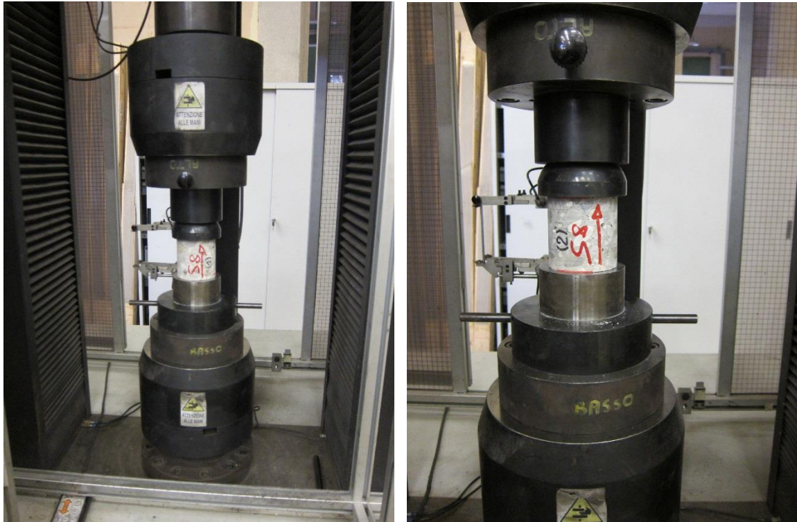
Figura 5-7: esecuzione della prova di schiacciamento
