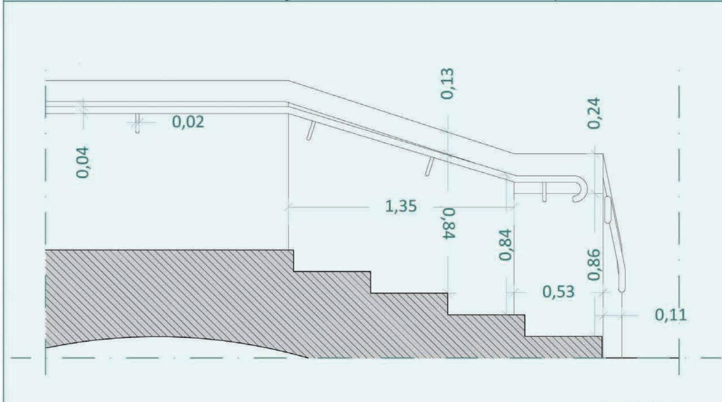
SEZIONE A-A' PARAPETTO\_SCALA 1:20
