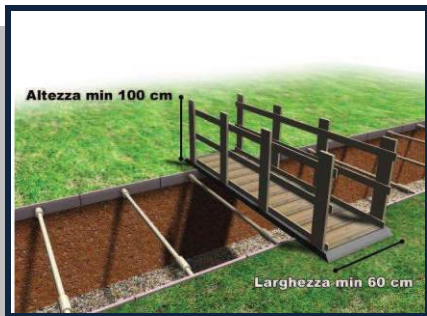
Passerelle per attraversamento dello scavo
