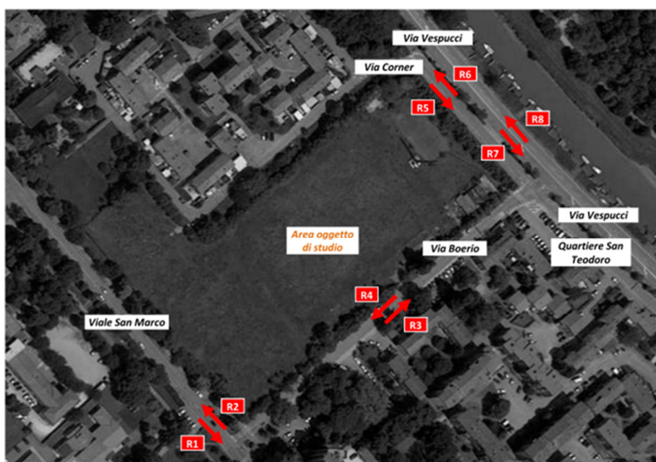
Sezioni di rilievo tramite strumentazione radar
