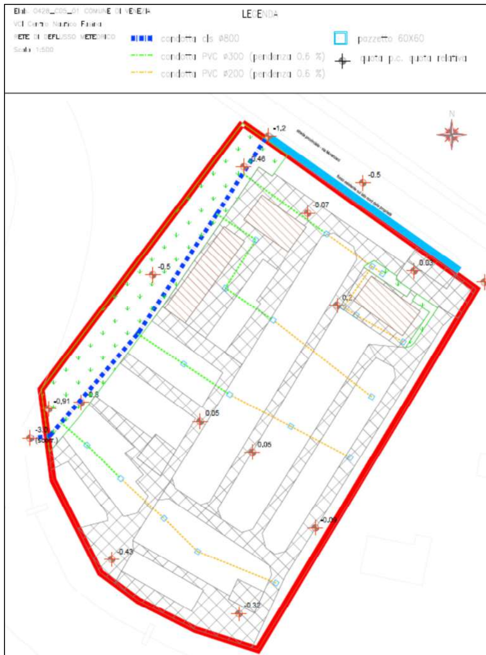
Figura 7.2 – Schema planimetrico della rete di deflusso meteorico di progetto
