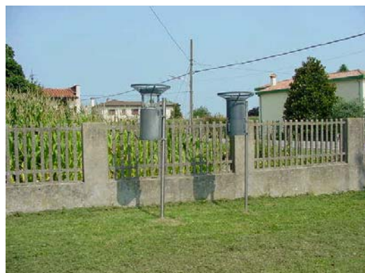
Figura 2 - Campionatori bulk per la raccolta delle deposizioni atmosferiche
