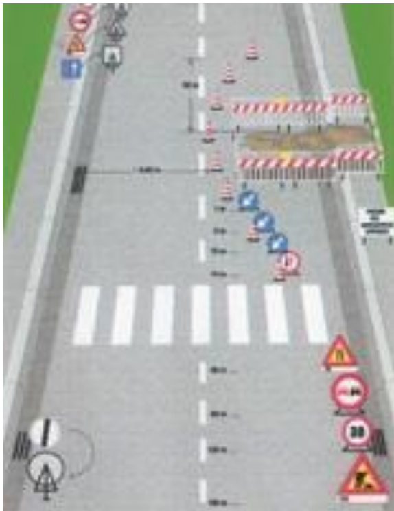
Figura 32 Esempio di organizzazione cantiere stradale
