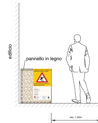
Depositi e stoccaggi Sabbia, materiale di risulta, etc.
