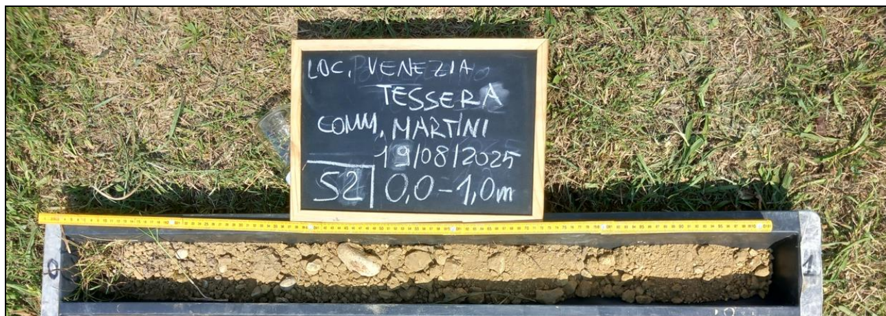
Foto cassetta con litologie del sondaggio S2
