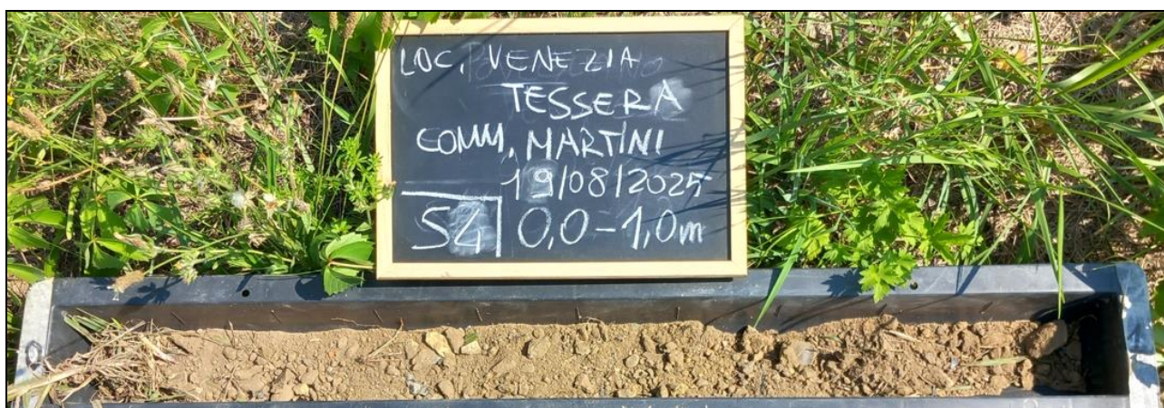
Foto cassetta con litologie del sondaggio S4
