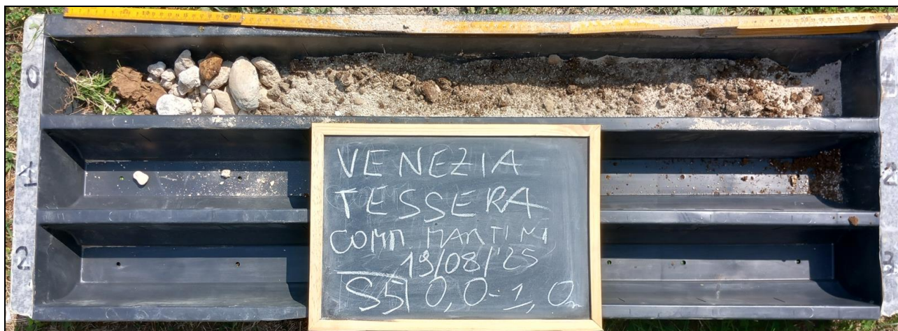
Foto cassetta con litologie del sondaggio S5
