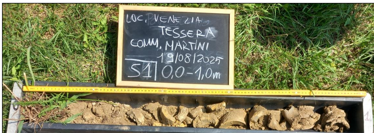
Foto cassetta con litologie del sondaggio S1
