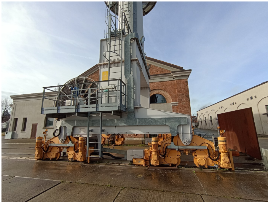
Fig. 4.4: Fotografia del basamento di una delle due gru Cimolai del Bacino di Carenaggio Medio
