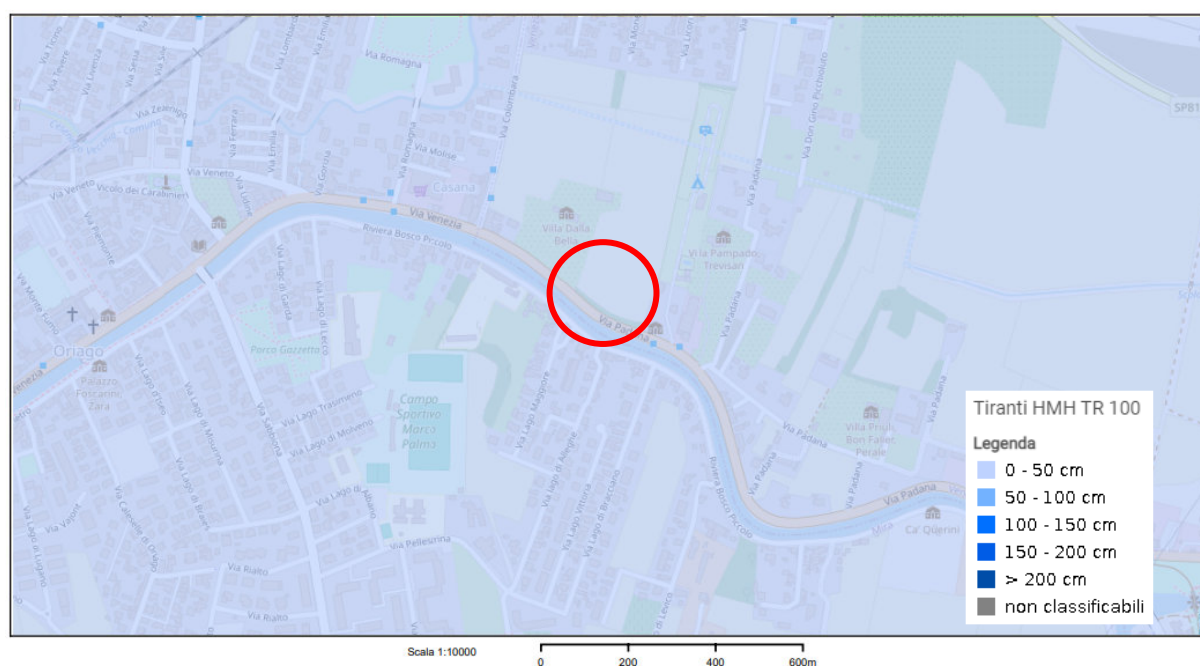
Figura 12 – Massimo tirante idrico che si realizza in seguito al verificarsi di un evento di piena con 30 < Tr < 100 anni: 0.0 < h < 0.5 m
