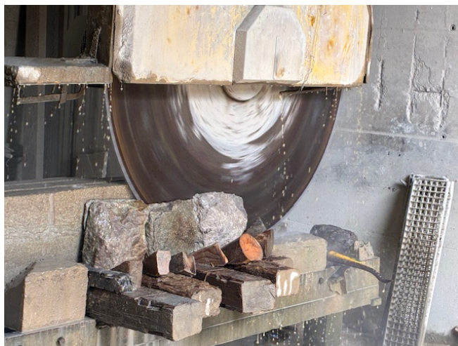
Fig. 11 - intervento di rifilatura dei masegni degradati in superficie
